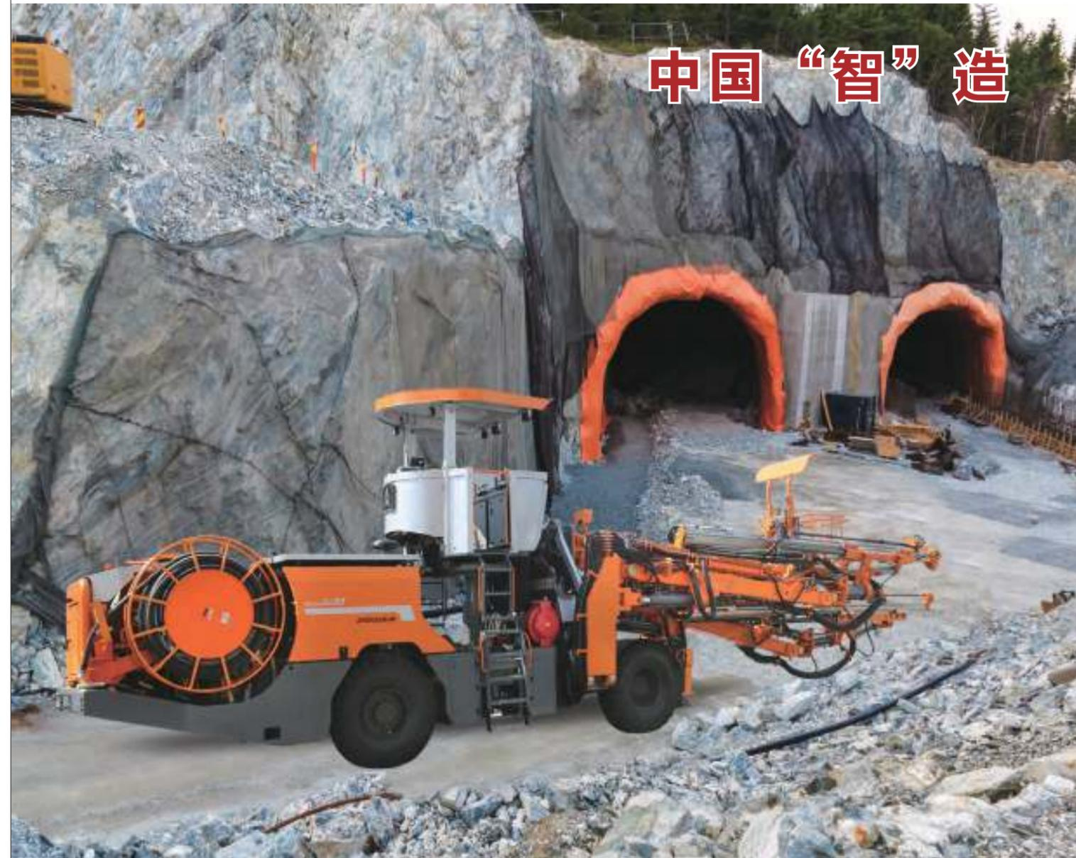
UJ33适用于公路、铁路、水电等地下工程和隧道施工。配有三条重型钻臂和一个服务平台，升降式驾驶室、自开式电缆及水管卷筒、自动黄油加注系统，使得操作维护更为方便。两个外侧钻臂配有鹰式臂座、可选配自动换钎机构，适用于更大断面的掘进、锚杆等应用。采用全液压先导比例控制方式，控制精准、故障率低。装备高频液压凿岩机，以满足客户的高效需求。
